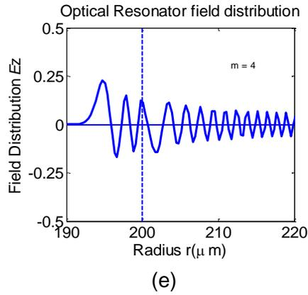
Fig. 4: Eigenmode field distributions for (a) m=0; (b) m=1; (c) m=2; (d) m=3; (e) m=4.
